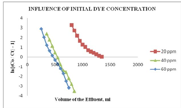
Fig. 2: Volume of the effluent Vs  $\ln(C_o/C_t - 1)$ .
