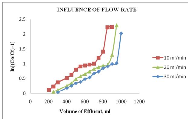
Fig. 8: Volume of the effluent Vs  $\ln(C_0/C_t - 1)$ .
